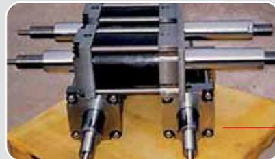
Cylindres pour presses à extrusion plastique
